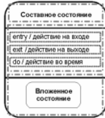
Рис. 3. Пример составной фигуры, представляющей составное состояние на диаграмме состояний UML (пунктирными прямоугольниками выделены границы дочерних фигур)
